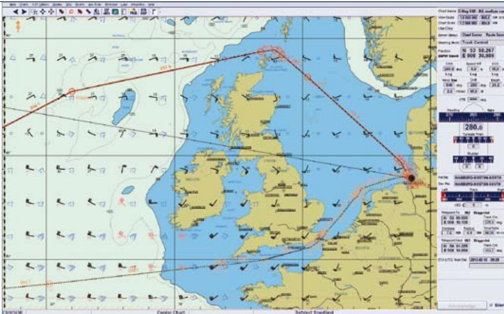
Wetterdaten als Overlay auf ECDIS-Bildschirm bei Raytheon-ECDIS
