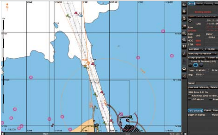
Umsetzung der Konstruktion von Standlinien in Transas Navisailor 4000
