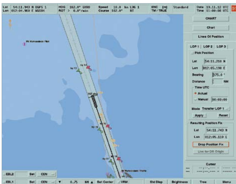
Umsetzung der Konstruktion von Standlinien bei SAM Chartplotter 1100
